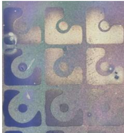
図 1. アクセプタ不純物をドーピングした r\text{-GeO}_2 薄膜の電気特性測定用サンプル
