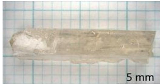
結晶を粉末状にし、X 線回折法で構造評価したところほとんどのピークが  $r\text{-GeO}_2$  に由来するものであると確認されました。 $r\text{-GeO}_2$  の結晶のファセット面を X 線回折法で評価したところ、ファセット面は(110)面であることが確認されました(図 2)。
